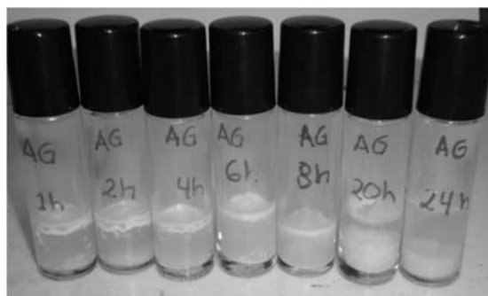
Figura 7. Foto tomada a las muestras obtenidas durante la disolución anódica de aluminio en el tiempo. Fuente: Los autores.
