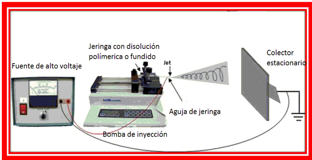
Figura 4. Esquema del equipo de electrohilado.
