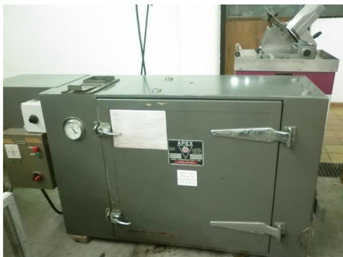
**Figura 1:** Secador piloto de charolas con sistema de secado convectivo.
