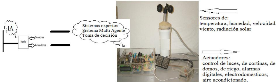
Figura 3. Un nodo especial del Sistema Inteligente Distribuido: Unidad meteorológica.
