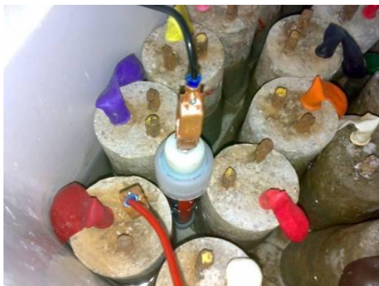
Figura 1. Mediciones de potenciales de corrosión.
