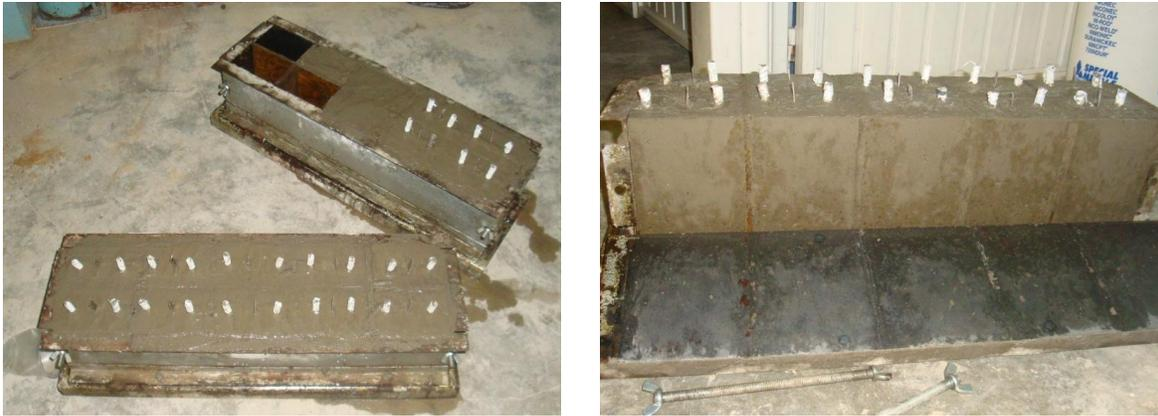
**Figura 2.** Elaboración y descimbrado de especímenes de prueba.
