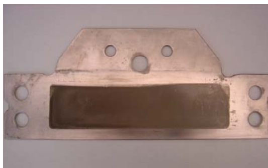
Figura 4. Depósito obtenido sobre el electrodo de A304 después de hacer una macroelectrólisis a potencial controlado de -910 mV en una solución proveniente de los desechos de los efluentes de la industria fotográfica y radiográfica.
